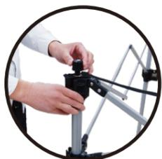
補強ベルトC (長) はフレーム間をクロスさせて
