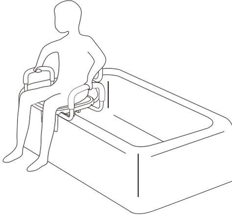
2. 固定解除レバーを押し、座面を回転させます。(90度毎に固定できます)
